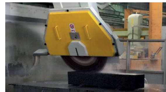
Inclined cuts. Tagli inclinati.
