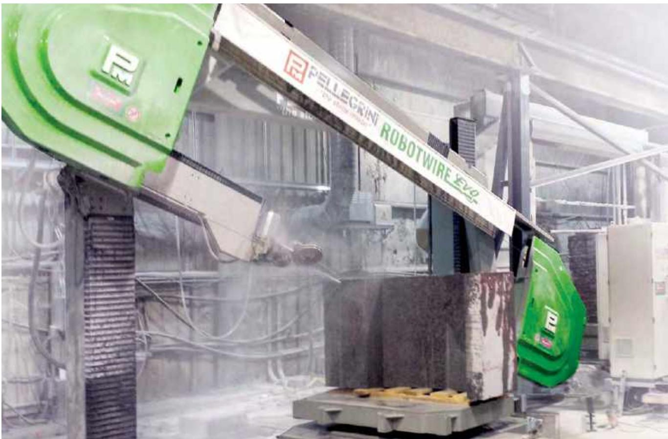
**Nuovo impianto di sagomatura a filo diamantato, dotato di sistema di CNC a 7 assi controllati per l'inclinazione del filo fino a 22,5°.**
